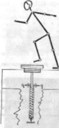
Рис. 41. Схема станка А-101 для отработки резонансного контакта спортсмена с покрытием ( $\omega_0 = 5-10 \text{ гц}$ )
